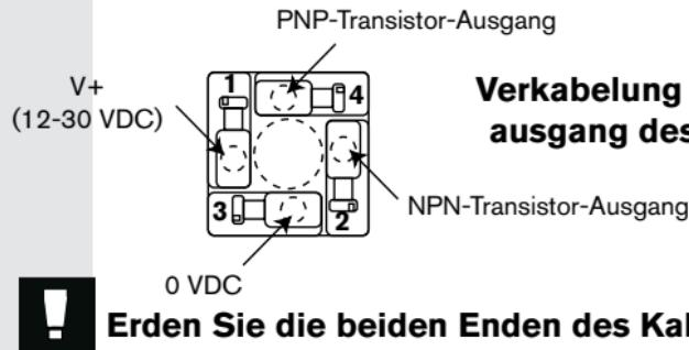
**Verkabelung als NPN / PNP Transistorausgang des Steckers EN 175301-803**
