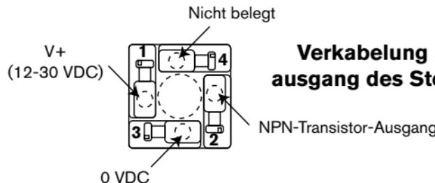
**Verkabelung als NPN Transistor-ausgang des Steckers EN 175301-803**
