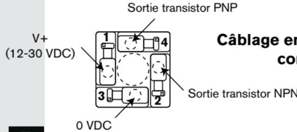
**Câblage en sortie transistor NPN / PNP du connecteur EN 175301-803**
