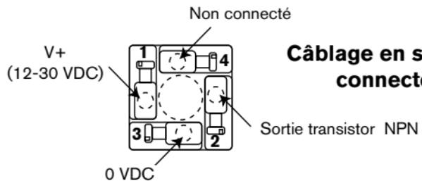
**Câblage en sortie transistor NPN du connecteur EN 175301-803**
